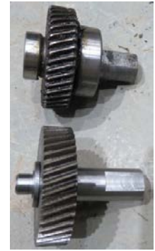
写真5 アーマチュア 写真6 メインシャフト (それぞれ、上が交換前、下が新品)
