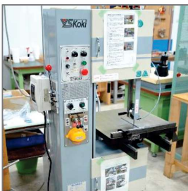
コンターマシン 板金の切断
