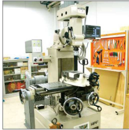
フライス盤 平面・溝の加工
