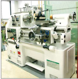
旋盤 円筒形状物の加工
