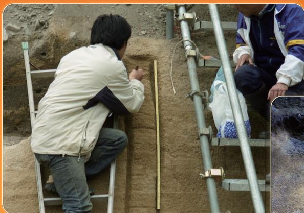
土石流堆積物の粒度分析試料の採取 (297地点)
