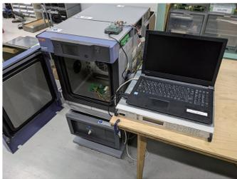
図3: 恒温槽による測定環境。
