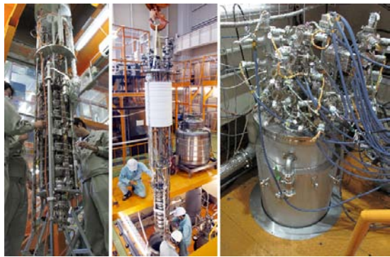
図4：縦測定（空洞性能測定）準備 左：クリーンルーム内、センサーの設置 中：クライオスタットに挿入 右：He 充填中
