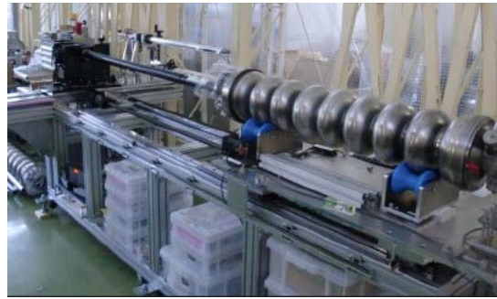
図3：内面検査カメラ（京都カメラ）
