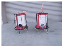
3号機 R/B屋上ダスト採取用機器
