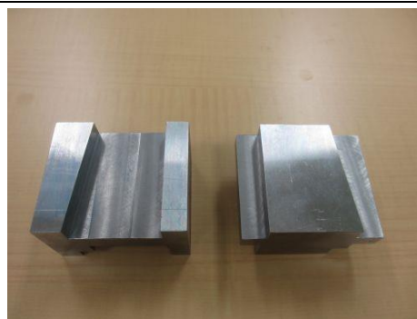
写真 8 仕上げ加工完了 (テーパ加工部)
