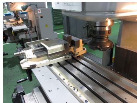
写真2 正面フライスによる6面体加工
