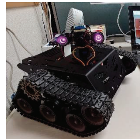
図2. ダクト調査ロボット
