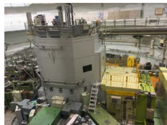
図 1：KUR と重水熱中性子設備
