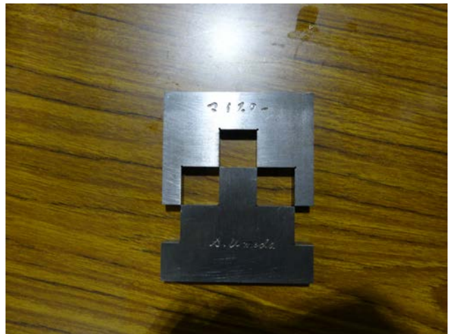
図5. 北九州マイスターのデモンストレーション例 (2枚の金属片は一分の隙間もなく組み合わさり、組んだ状態で上下左右に完全な平行が保たれている。さらに片方の金属片を裏返しにしても同様である。)
