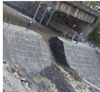
図-4 実験林場での破堤実験の様子
