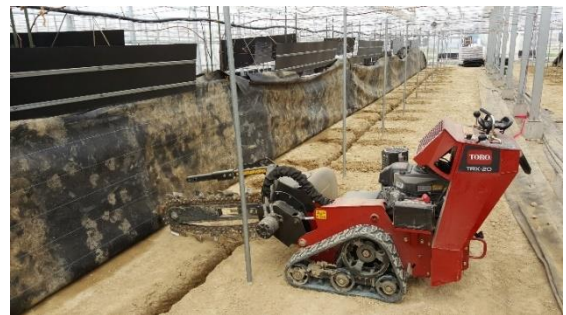
図1. トレンチャーを用いた掘削風景
