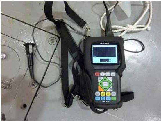
図1 超音波厚さ測定器
