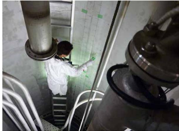
図4 タンク内超音波測定
