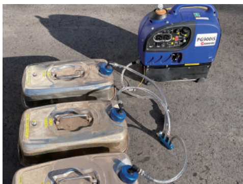
ポータブル発電機 連続3日間連続動作可能 (JP GENERATORS社製)
