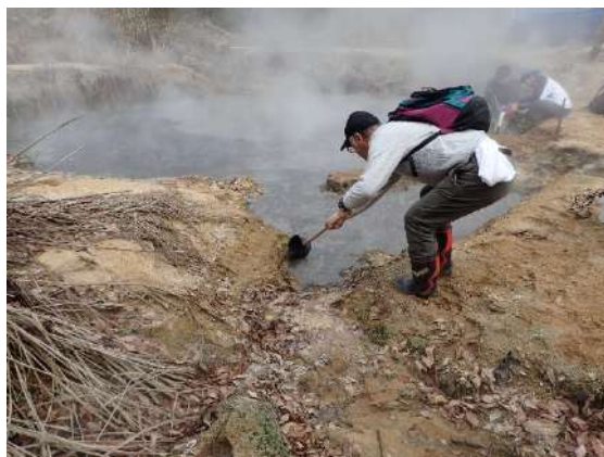
図4. 野矢地獄での温泉水のサンプリング
