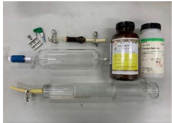
図1. ガスサンプリングの準備機材
