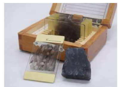
図 5. 薄片とその製作に用いた石
