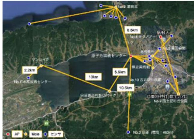
図 11 島根県松江市および宍道湖周辺でおこなった ZETA によるモニタリング地点間の接続試験。10 km 以上の伝搬距離を達成しつつ、複雑な地形や市街地でも主要なモニタリング地点にあるセンサ（端末）と AP（基地局）を MOTE（中継局）で機動的に結ぶことに成功した。
