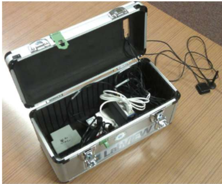
図 2 KURAMA-II 車載機。筐体の大きさは 34.5 cm×17.5 cm×19.5 cm で、この中に CsI(Tl) 検出器と組み込みコンピュータ、通信モジュールが収められている。シガープラグ等からの電源供給で自動的に測定を開始する。
