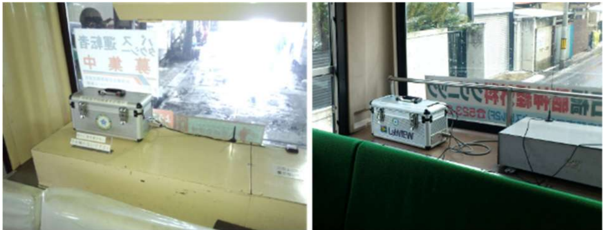
図 4 福島県内の路線バスに搭載された KURAMA-II。左が会津乗合自動車、右が福島交通のもの。バスの電源に接続されているため、バス運行時の自動的な測定が実現している。
