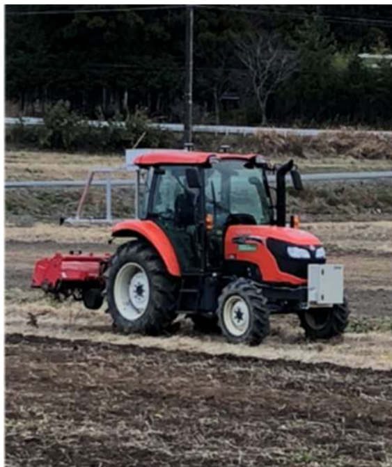
図 9 実証試験中の地力が見える化ロボット。トラクタに KURAMA-II による土壤汚染密度測定機能とハイパースペクトル解析による土壤肥沃度評価機能および高精度 GNSS ガイダンスシステムによる高精度測位と運転補助機能を搭載している。これをクラウドで処理して圃場の状態をリアルタイムで可視化する。
