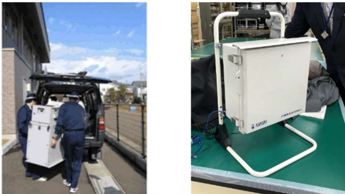
図10 従来の可搬型モニタリングポスト（左）と KURAMA-II をベースとした可搬型モニタリングポスト（右）。大幅な小型軽量化と性能向上を達成している。
