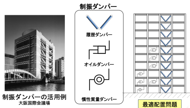
図1 ダンパー配置問題：さまざまなダンパーを架構内にどのように配置すべきかを数理的に導く 2
