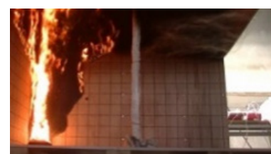
(c) 15分：高温の未燃ガス層の下端に引火
