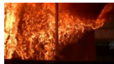
(d) 18分30秒：フラッシュオーバーの発生
