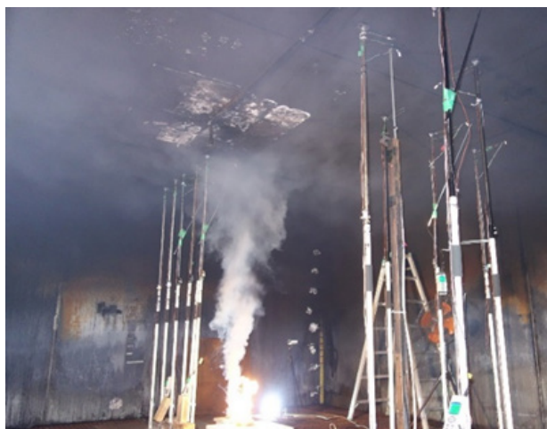
図1 天井近傍に配置したセンサーでの火災気流の測定 (平成28年度東京理科大学共同利用・共同研究による実験 5 )
