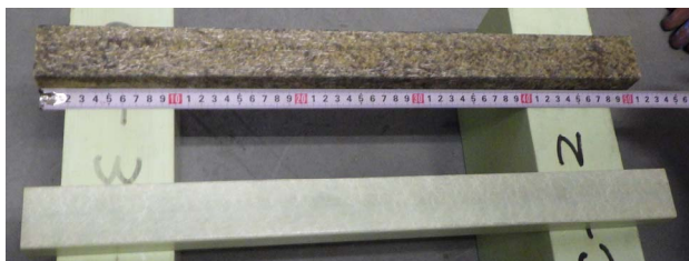
図-1 供試体（上が暴露あり，下が暴露なし）
