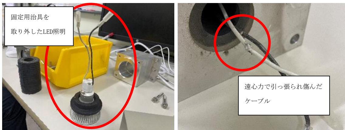
写真3 LED照明ケーブルの様子
