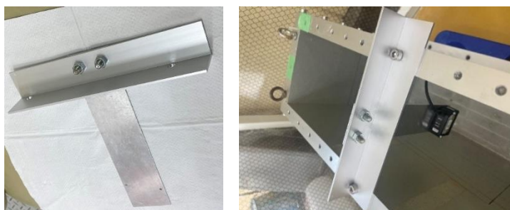
写真3 : L型アングルを用いたジグ
