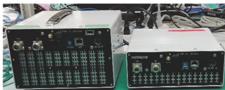
実用化したVHF帯公共ブロードバンド移動通信システム装置 (左: 5W出力機, 右: 1W出力機)
