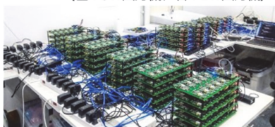
大規模マルチホップメッシュ型多段中継通信実証試験
