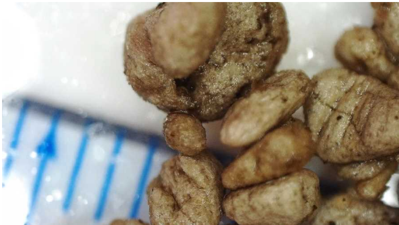
Sample B . USB 顕微鏡 (MJ-ICT16 型) 使用. 倍率 50 倍. 背景の目盛りは 1mm. 2mm 以下の粒でも微小なわれ目の入っているものがある.
