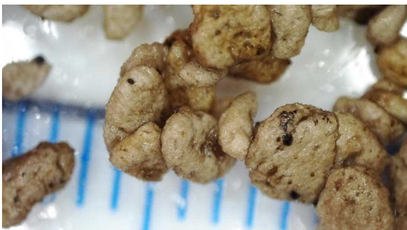
Sample E USB 顕微鏡 (MJ-ICT16 型) 使用. 倍率 50 倍. 背景の目盛りは 1mm. 2mm 以下の粒でも微小なわれ目の入っているものがある. 表面の透明な粒は海水由来の食塩の結晶と思われる.
