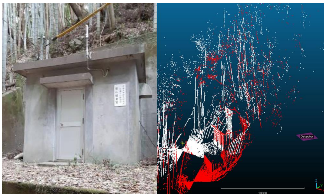
図3：郡山観測室外観(左)と、小型LiDAR装置により撮影した周囲の点群地形(右)。
