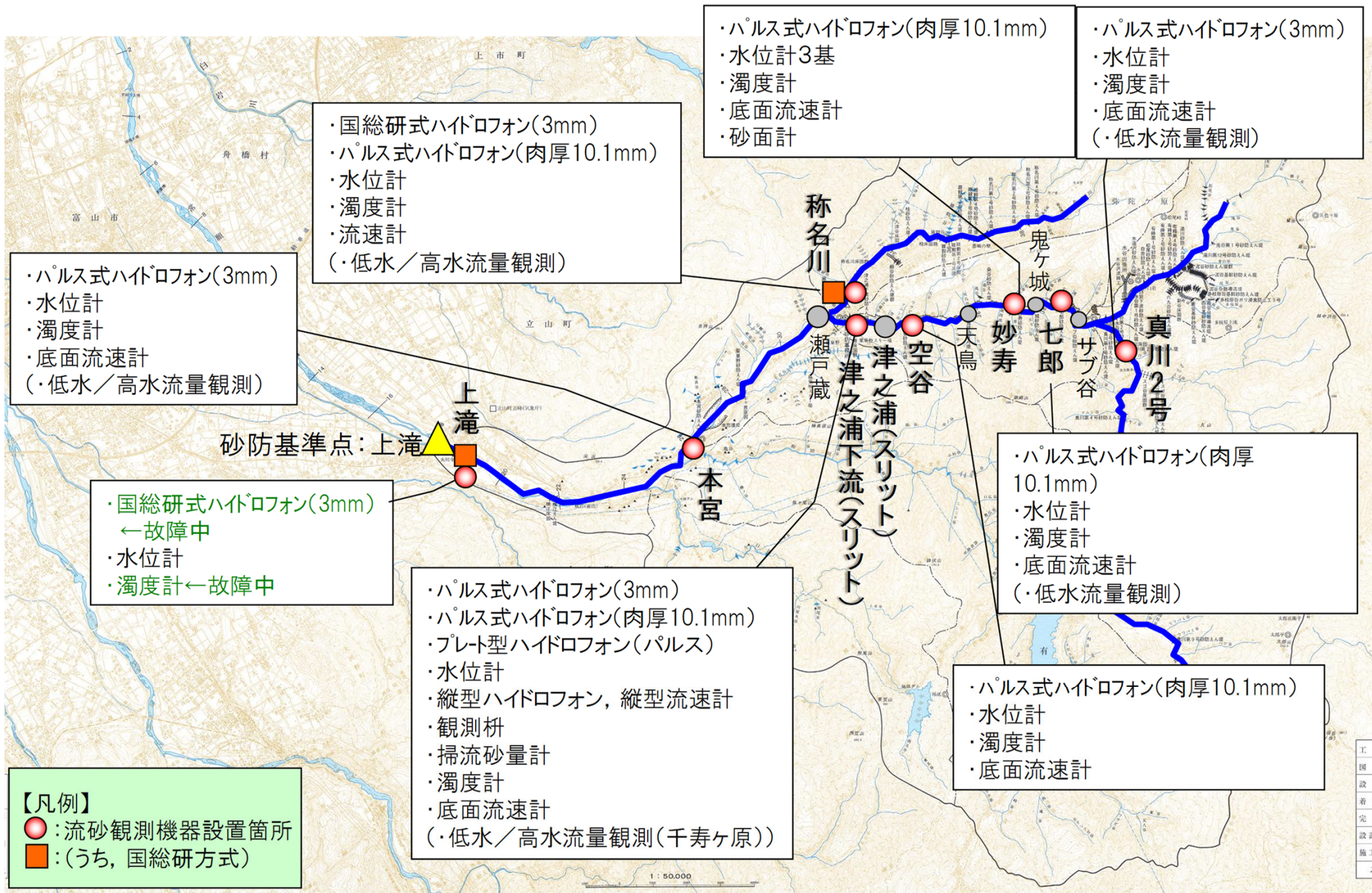
図 (再掲) 常願寺川における観測所と設置機器
