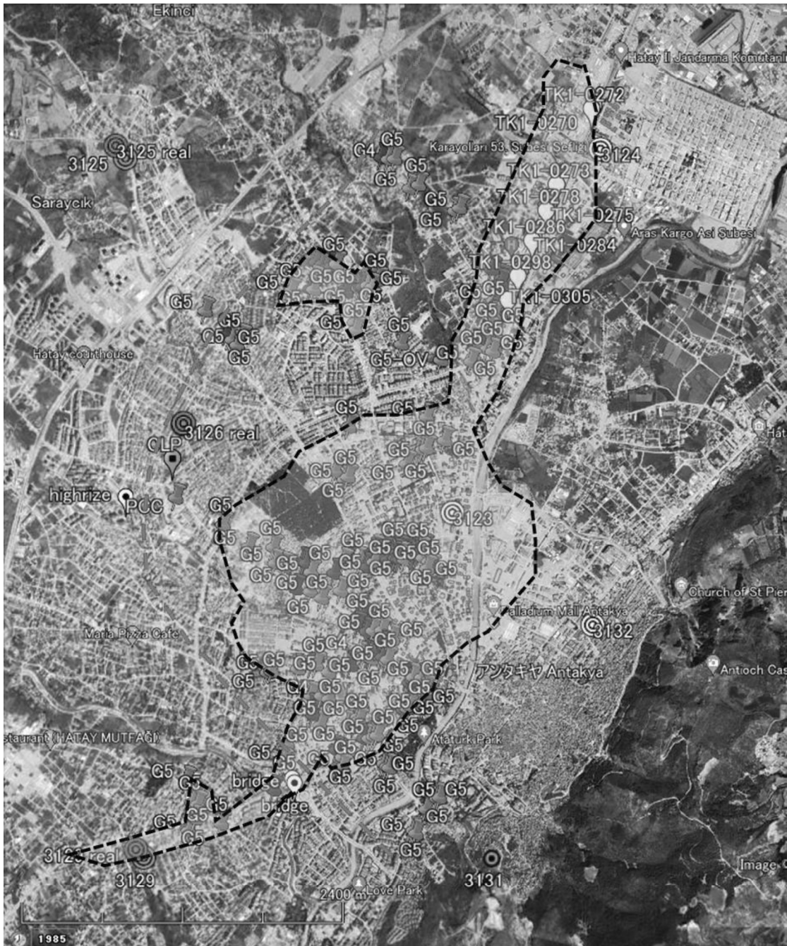
図-5 Antakya 市における Grade-5 と Grade-4 の被害に絞り込んだ建物被害マッピングの結果
