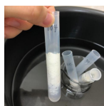
20%架橋度のピロリドン樹脂を用いた吸着挙動。
