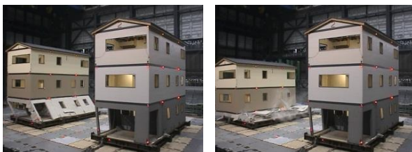
3 階建て実大木造住宅の振動台実験
