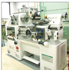
旋盤 円筒形状物の加工
