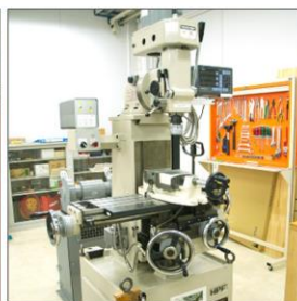
フライス盤 平面・溝の加工
