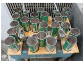
図 5 円筒型枠を設置した様子
