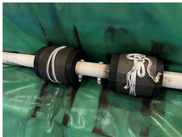
図3. 液化室ガスバッグのボルト対策
