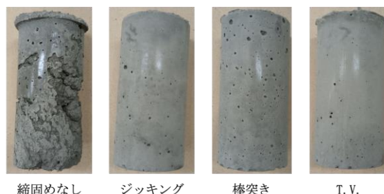
図 8 脱型後の供試体外観
