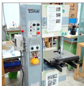
コンターマシン 板金の切断
