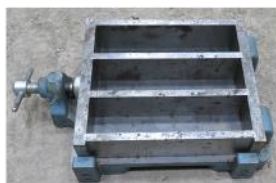
図 3 セメント強さ試験 供試体用型枠
