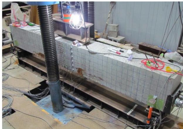
写真 4.2-1 載荷試験の状況
