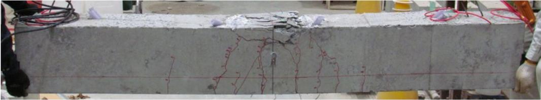
写真 4.2-2 載荷試験後の破壊状況 (No. I -1)
