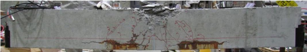
写真 4.2-3 載荷試験後の破壊状況 (No. I -2-1)
