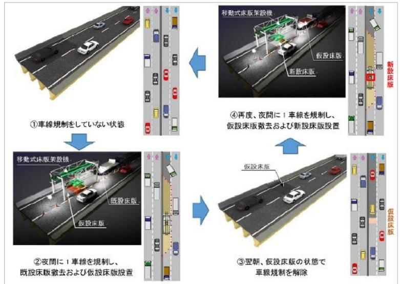
図 1.4-3 新たな床版取替え工法<sup>9)</sup>
