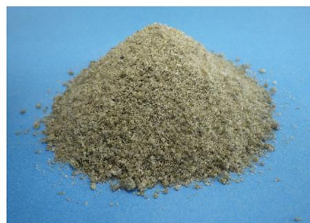
写真 5.1-1 高炉スラグ細骨材(BFS)
