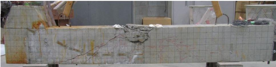
写真 4.3-3 載荷試験後の破壊状況 (No. II-2)
