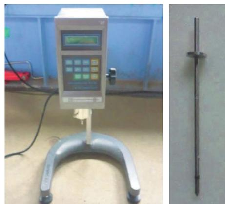
写真 5.3-7 粘度計とローター
