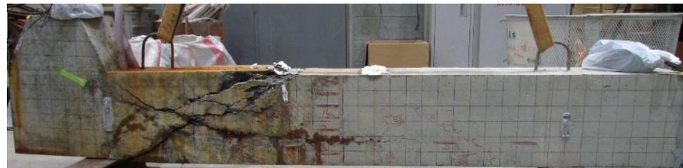
写真 4.3-4 載荷試験後の破壊状況 (No. II-3)
