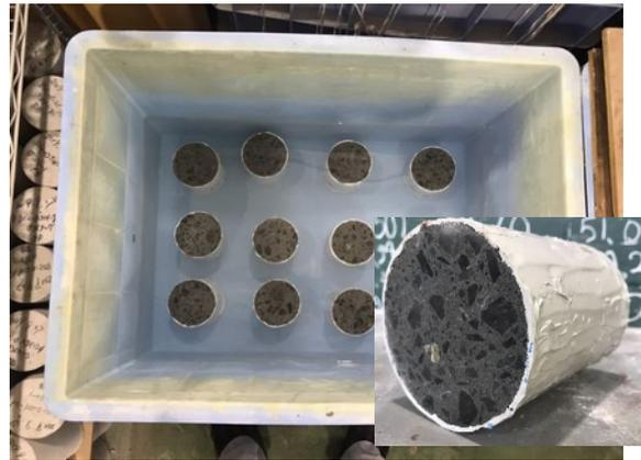
写真 5.2-3 塩化物浸透試験の試験体浸漬状況
