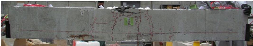
写真 4.2-4 載荷試験後の破壊状況 (No. I -2-2)
