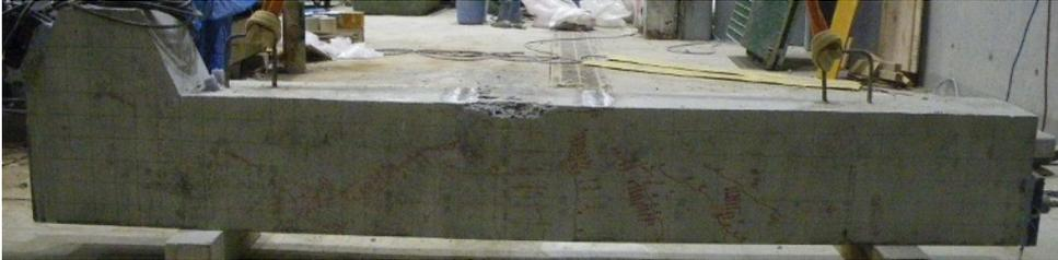
写真 4.3-2 載荷試験後の破壊状況 (No. II-1)
