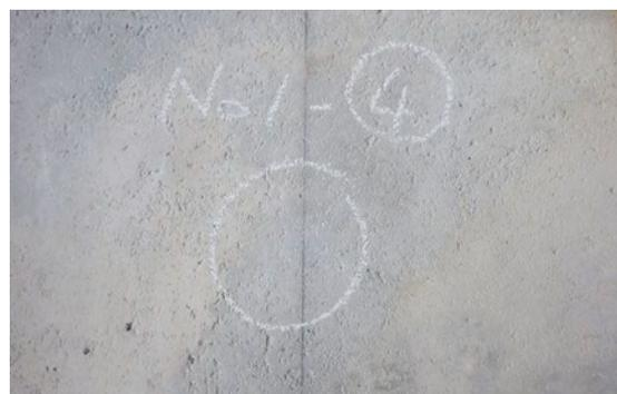
写真 5.3-4 No.1 試験体の仕上がりが粗な部分
