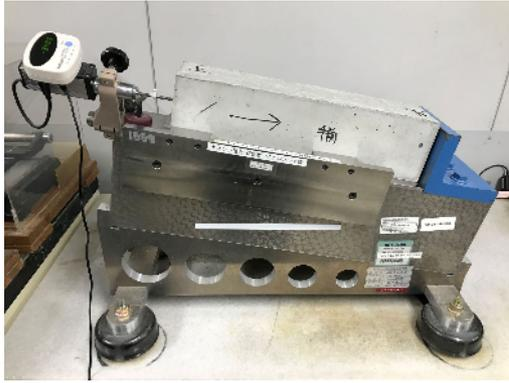
写真 5.4-2 乾燥収縮試験状況
