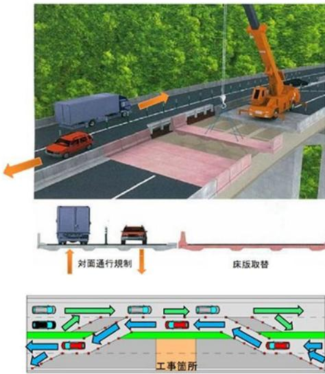
図 1.4-2 床版取替工事の交通規制<sup>7)</sup>
