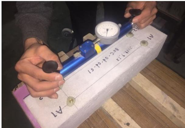
写真 5.2-4 乾燥収縮試験状況
