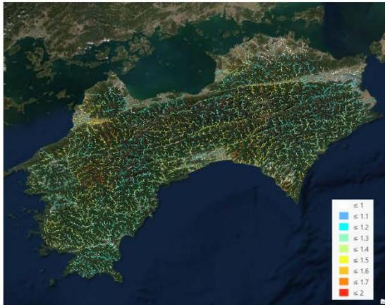
全国を150 m空間分解能でカバーする降雨流出氾濫(RRI)モデルに、d4PDFのダウンスケーリング結果(SI-CAT: 5km, 372年分)を入力して全ての河川の流量確率を算定。100年確率洪水流量の、4度上昇シナリオ下での増加率を示す。
