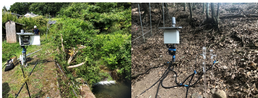
写真1. 池ノ尾川での雨量・水位観測 写真2. 志津川地内における観測点
