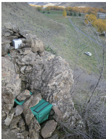
ニュージーランド南島クラレンス断層付近に設置された地震計
