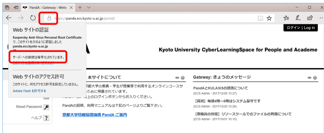
図 47 WWW での暗号通信と証明書の確認
