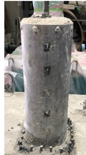
図-26 載荷終了後の取り出した鋼管拘束コンクリートヒンジ
