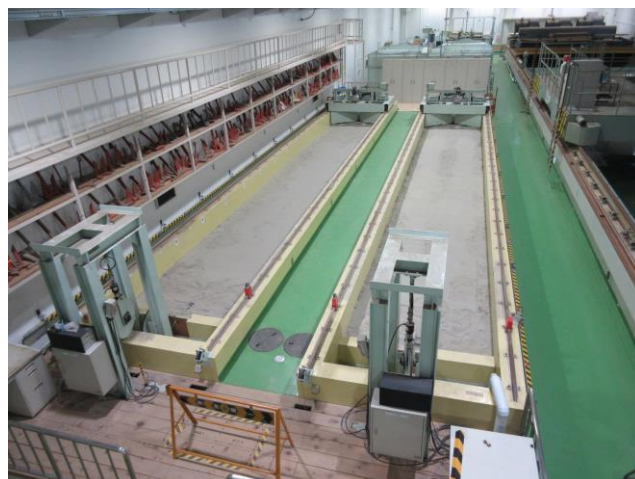
図 7 アンカー水槽
