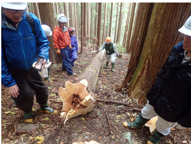
樹木内部の腐朽の観察
