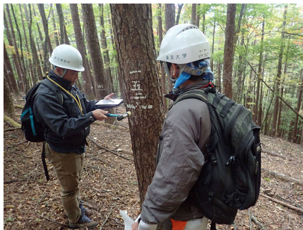
打撃音樹内腐朽簡易診断装置の実習
