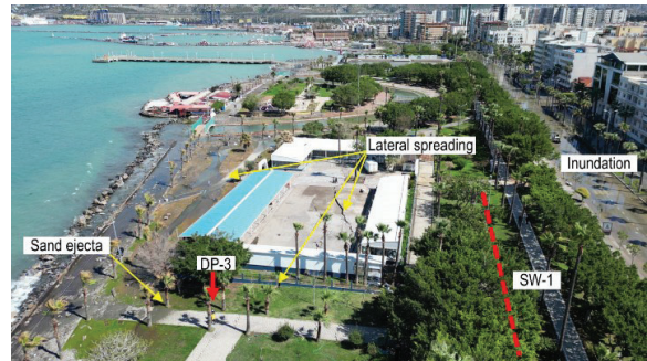
図-28 Iskenderun の海岸埋立地の液状化被害
