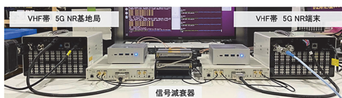
図 2：開発した超広域小型自営系 5G システムの評価系
