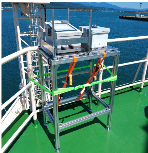
新青丸に設置したマイクロ波放射計と雲カメラ
