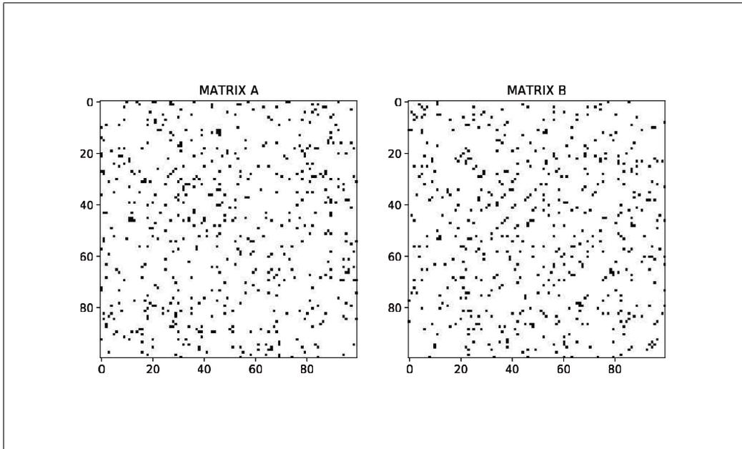
図 1: 0-1 対称行列  $A$  と  $B$  の非零パターン例 ( $N = 100$ , 非零率 5%)
