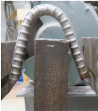
写真3 試験片の両端を押し合う様子
