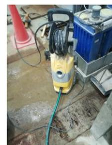
図2 高压洗浄機
