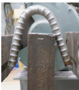
写真3 試験片の両端を押し合う様子
