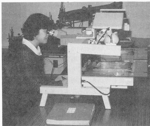
資料複写閲覧室に設置され空中写真図化装置
