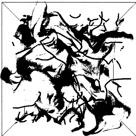
図 4: 流体面と乱流中の秩序渦構造. 黒い曲線群は, 流体面の近くにある低圧力渦 [6,7] の中心軸を表す. R_\lambda = 57 . t = 5\tau_\eta .
