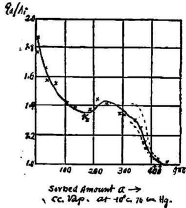
を有することは周知の事である。此の場合に吸着量と  $q_a/\Delta_i$  ( $q_a$ : 微分吸着熱,  $\Delta_i$ : 内凝結熱) との關係を書けば第二圖の様になる。此の圖に於て  $k$  點に於て極小を示し, 500cc に於て  $q_a/\Delta_i = 1$  となる。即ち吸着熱は通常の凝結熱と等しくなる。
