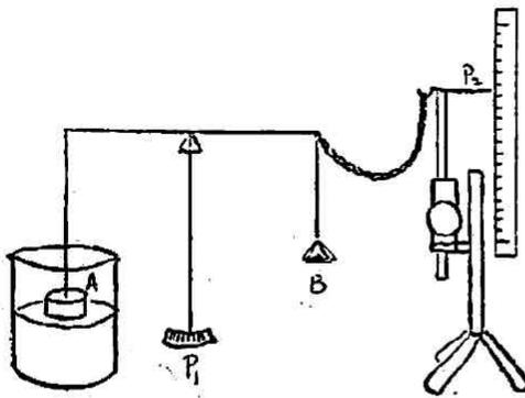
面を調節し、次に大皿皿と吊合ふ程度の錘を B に載せ、後は右端の金鎖を支へる指針  $P_2$  を徐々に下して天秤の指針  $P_1$  が動き始めとする時の荷重を求めたのである。この荷重は皿の重さと、皿の下縁に沿ふて働く表面張力の作用との和に對應するものである。この場合溶液を
