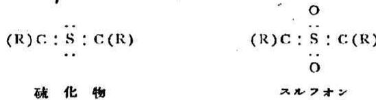
硫化エチルの解毒法： 試験反應は矢張クロトン酸の水素化で、第九圖の如く反應經過は  $H_2$  の吸収量で示される。毒物硫化エチルを入れると反應は起らぬ。圖上の僅かの吸収は單なる物理的溶解に基づくものである。次亜鹽素酸ナトリウムを酸化劑として硫化エチルを酸化してチエチルスルフォンにして後試験反應系に入れると、硫黄含量に於て先の硫化エチルと同量の場合全然毒性が現はれない、さて水素反應系に於て毒物硫化エチルが含まれてゐる時、硫化エチル及夫から變化するスルフォンの何れをも分離しないで硫化エチルの毒性を如何なる程度迄消す事が出来るかの吟味である。毒物を解毒 (Detoxication) する爲に撰ぶべき酸化條件に
