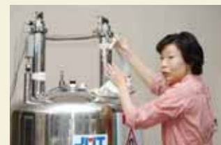
NMR装置は強い磁気を持っているため、取り扱いの際には注意が必要です。磁気カード、腕時計は近づけると壊れます。はさみ、ピンセット等は吸い付けられて危険です。
