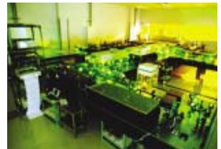
T † レーザーを運転中の様子。緑色は励起用レーザー光の散乱、赤色は増幅器の結晶からの蛍光
