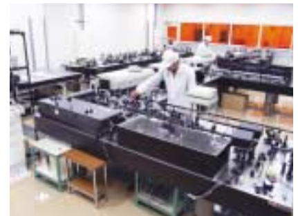
レーザー科学棟に設置されているT † レーザー (Table-top Ten TW Ten Hz Tunable Ti:sapphire laser)
